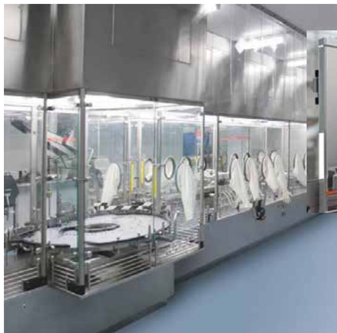
La riempitrice per liquidi farmaceutici in ambiente asettico di Bausch + Ströbel.
